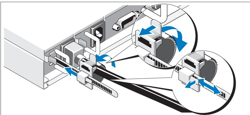
Ελευθερώστε το μάνδαλο στη μονάδα βάσης συγκράτησης και τραβήξτε το δακτύλιο σύσφιξης προς το άκρο της λωρίδας. Ανοίξτε το δακτύλιο σύσφιξης και εισάγετε το καλώδιο τροφοδοσίας. Κλείστε και ωθήστε πίσω το δακτύλιο σύσφιξης, μέχρι να είναι όσο το δυνατό πιο κοντά στο σύστημα. Ελέγξτε για να διασφαλίζετε ότι το καλώδιο τροφοδοσίας είναι στερεωμένο στο σύστημα.
