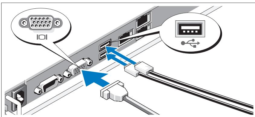
Schließen Sie die Tastatur, die Maus und den Bildschirm an (optional). Die Anschlüsse auf der Rückseite des Systems sind mit Symbolen gekennzeichnet, mit denen sich die entsprechenden Kabel zuordnen lassen. Denken Sie daran, gegebenenfalls die Schrauben am Stecker des Bildschirmkabels festzuziehen.
