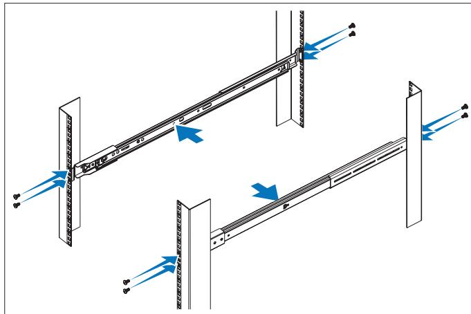
**2** Совместите внутренние направляющие с направляющими стойки и продвиньте систему по этим направляющим до фиксации защелки.
