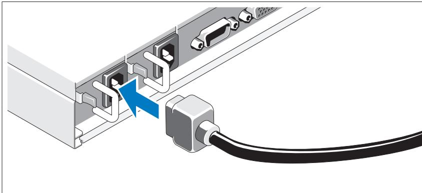
חבר את כבלי החשמל של המערכת למערכת, ואם אתה משתמש בציג, לחבר את כבל החשמל של הציג לצג. לחבר את הקצה השני של כבל החשמל לשקע חשמלי מוארך או למקור מתח אחר, כגון מערכת אל-פסק (UPS) או יחידת חלוקת מתח (PDU).
