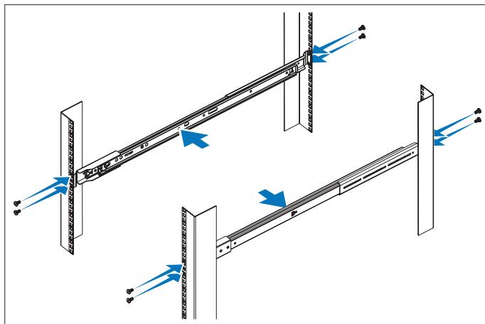
**2** Wyrównaj szyny wewnętrzne z prowadnicami szafy typu rack i przesuwaj system w prowadnicach do momentu zatrzaśnięcia się blokady.
