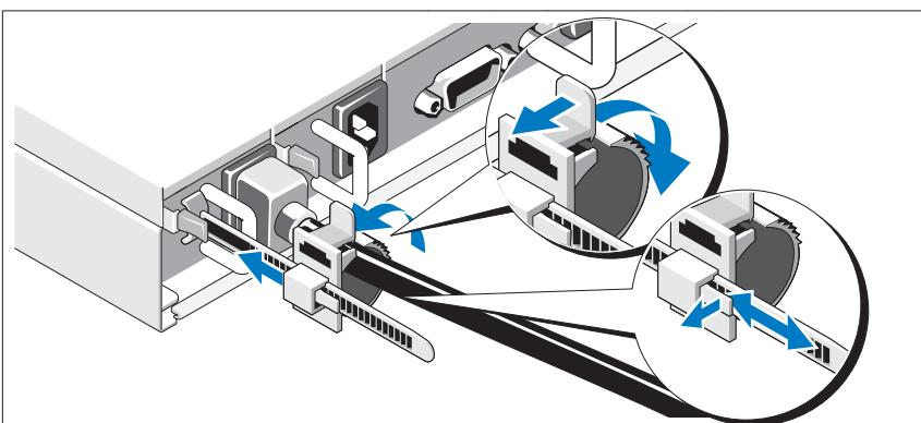
Zwolnij zatrzask na elemencie podtrzymującym i pociagnij pierścień zaciskowy w kierunku końca listwy. Otwórz pierścień zaciskowy i włóż kabel zasilania. Zamknij i z powrotem wsuń pierścień zaciskowy umieszczać go możliwie najbliżej systemu. Upewnij się, że kabel zasilania jest dobrze podłączony do systemu.
