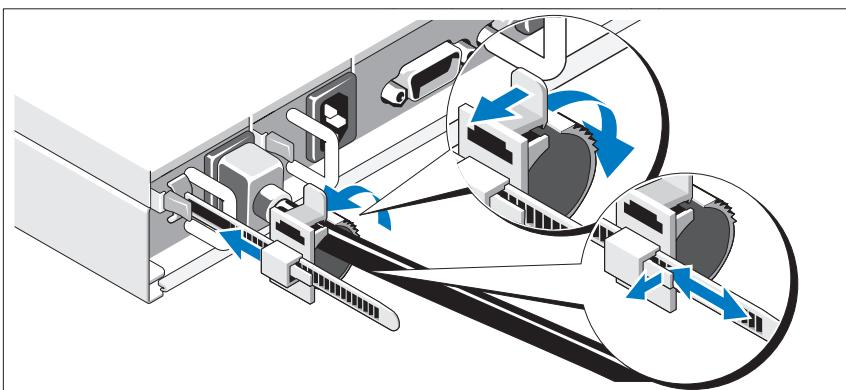
Разблокируйте защелку на стопорном устройстве и продвиньте фиксирующее кольцо до конца шины. Откройте фиксирующее кольцо и вставьте в него кабель питания. Закройте и продвиньте фиксирующее кольцо в положение, максимально приближенное к корпусу системы. Убедитесь, что кабель питания надежно прикреплен к системе.
