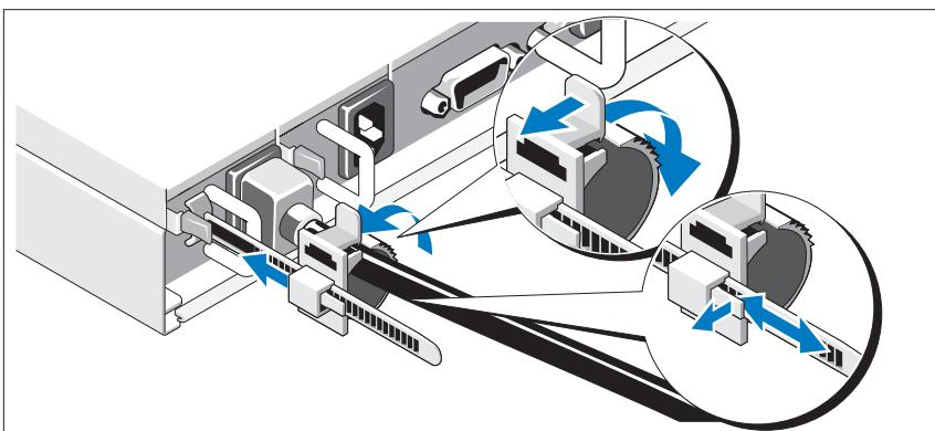
Poussez le loquet de l'unité de fixation vers l'arrière et tirez le collier de serrage vers l'extrémité de la bande crantée. Ouvrez le collier de serrage et insérez le câble d'alimentation. Fermez le collier de serrage et poussez-le en arrière le plus près possible du système. Vérifiez ensuite que le câble d'alimentation est bien fixé au système.
