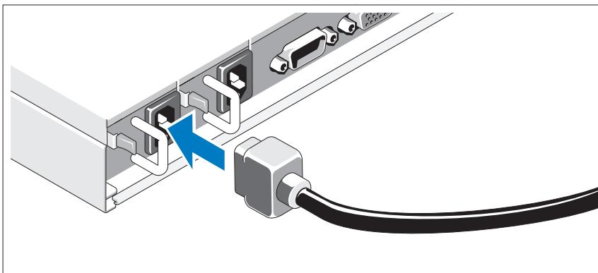
Připojte napájecí kabely k systému, a pokud používáte monitor, připojte napájecí kabel také k monitory. Poté zasuňte druhý konec napájecích kabelů do uzemněné elektrické zásuvky nebo je připojte k samostatnému zdroji napájení, například ke zdroji nepřerušitelného napájení (UPS) nebo jednotce rozvaděče (PDU).
