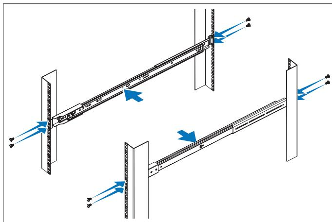
**2** Alinee los rieles interiores con los rieles deslizantes del rack e inserte el sistema en los rieles deslizantes hasta que el pestillo de cierre quede asentado en su lugar.
