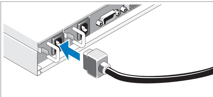
Συνδέστε το(τα) καλώδιο(α) τροφοδοσίας του συστήματος στο σύστημα και, εάν χρησιμοποιείτε οθόνη, συνδέστε το καλώδιο τροφοδοσίας της οθόνης στην οθόνη. Τοποθετήστε την άλλη άκρη των καλωδίων τροφοδοσίας σε γειωμένη πρίζα ή σε ξεχωριστή πηγή ηλεκτρικού ρεύματος, όπως είναι ένα σύστημα αδιάλειπτης τροφοδοσίας (UPS) ή μια μονάδα διανομής ρεύματος (PDU).
