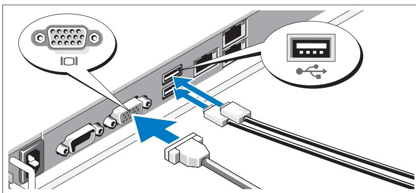
Подключите клавиатуру, мышь и монитор (дополнительно).
