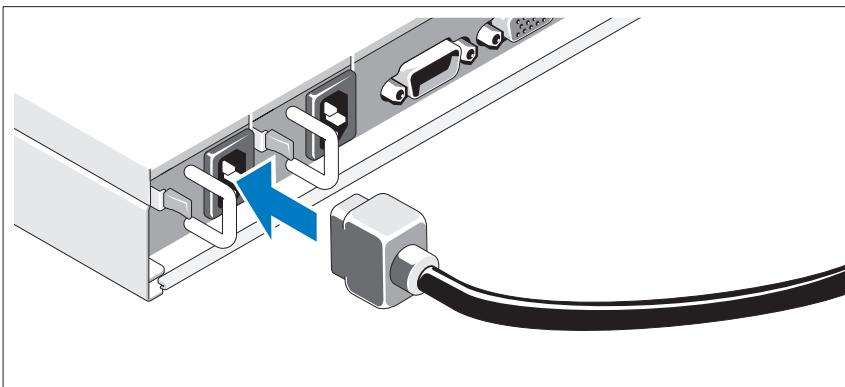
Podłącz odpowiednie kable zasilania do systemu oraz do monitora, o ile używasz monitora. Podłącz drugą końcówkę kabli do uziemionego gniazdka elektrycznego lub oddzielnego źródła zasilania, np. do zasilania bezprzerwowego (UPS) lub do jednostki rozdziału zasilania (PDU).
