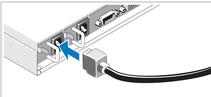
Conecte los cables de alimentación al sistema y, si se utiliza un monitor, conecte el cable de alimentación correspondiente al monitor. Conecte el otro extremo del cable de alimentación a una toma eléctrica con conexión a tierra o a otra fuente de energía, como por ejemplo un sistema de alimentación ininterrumpida (SAI) o una unidad de distribución de alimentación (PDU).
