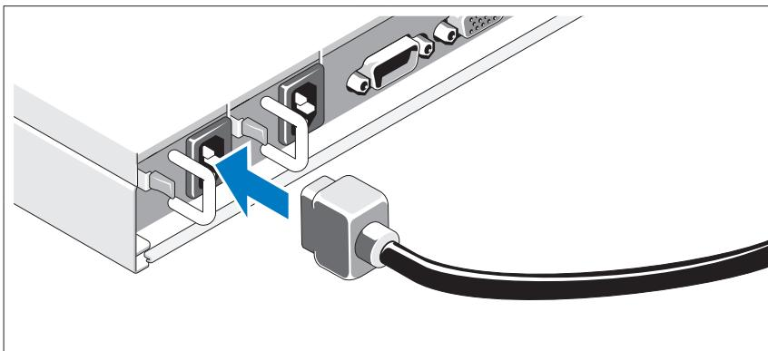
Verbinden Sie die Netzstromkabel mit dem System sowie gegebenenfalls mit dem Bildschirm. Verbinden Sie das andere Ende des Kabels jeweils mit einer geerdeten Steckdose oder mit einer separaten Spannungsquelle, etwa einer unterbrechungsfreien Stromversorgung (USV) oder einem Stromverteiler (PDU).
