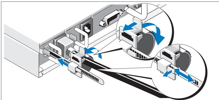
Libere el pestillo de la unidad de retención y empuje el anillo de sujeción hacia el final de la banda. Abra el anillo de sujeción e inserte el cable de alimentación. Cierre el anillo de sujeción y empújelo hacia atrás hasta que quede tan cerca del sistema como sea posible. Compruebe que el cable de alimentación quede bien fijado al sistema.
