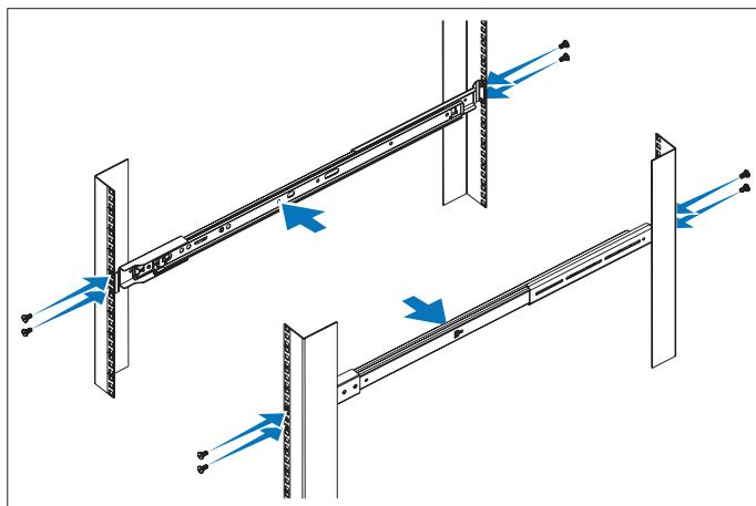
**2** Alignez les rails intérieurs avec les rails coulissants du rack et poussez le système dans ces derniers jusqu'à ce que le loquet de verrouillage s'enclenche.
