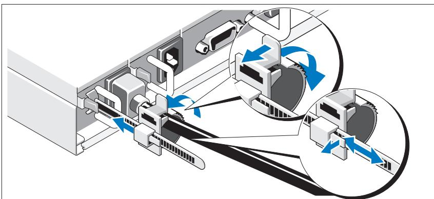
Lösen Sie die Sperrklinke an der Haltevorrichtung und ziehen Sie den Klemmring zum Ende des Streifens. Öffnen Sie den Klemmring und führen Sie das Netzstromkabel ein. Schließen Sie den Klemmring und schieben Sie ihn so nah wie möglich an das System zurück. Überprüfen Sie, ob das Netzstromkabel angemessen am System gesichert ist.
