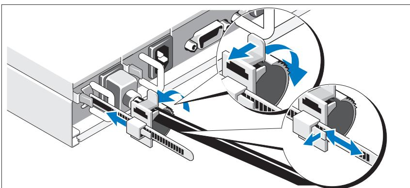
Uvolněte západku na zajišťovací jednotce a zatáhněte upínací kroužek směrem ke konci pásku. Otevřete upínací kroužek a vložte do něj napájecí kabel. Zavřete upínací kroužek a zatlačte jej zpět co nejbliže k systému. Zkontrolujte, zda je napájecí kabel připevněn k systému.
