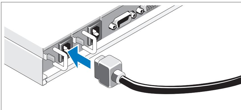
Connectez le ou les câbles d'alimentation au système et, si vous utilisez un moniteur, connectez son câble d'alimentation. Branchez ensuite l'autre extrémité des câbles d'alimentation sur une prise de courant mise à la terre ou sur une source d'alimentation autonome, par exemple, un onduleur ou une unité de distribution de l'alimentation (PDU).
