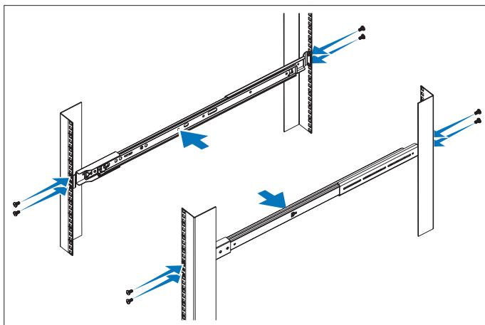
**2** Ευθυγραμμίστε τις εσωτερικές ράγες με τις ράγες ολίσθησης του ραφιού και αθήστε το σύστημα μέσα στις ράγες ολίσθησης, μέχρι το μάνδαλο να ασφαλίσει στη θέση του με κλικ.
